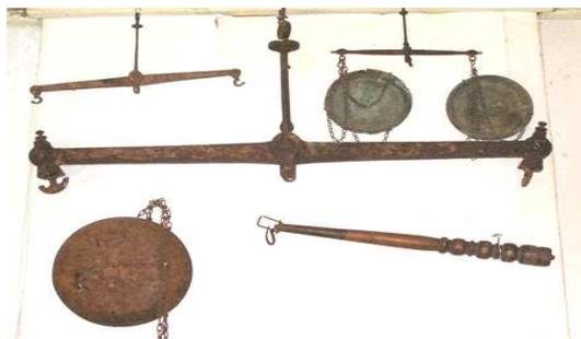
А несколько позже появились неравноплечные весы с подвижной гирей—безмен. Безмен—простейшие рычажные весы. Так называемый русский безмен—металлический стержень с постоянным грузом на одном конце и крючком или чашкой для взвешиваемого предмета на другом.
