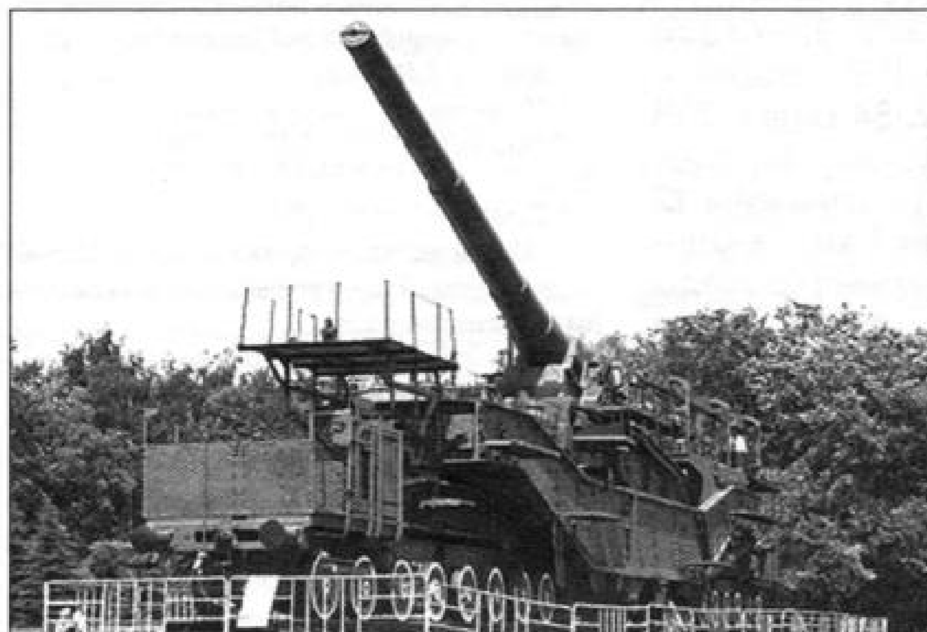
Железнодорожный транспортёр ТМ-III-12 с 305-мм пушкой
