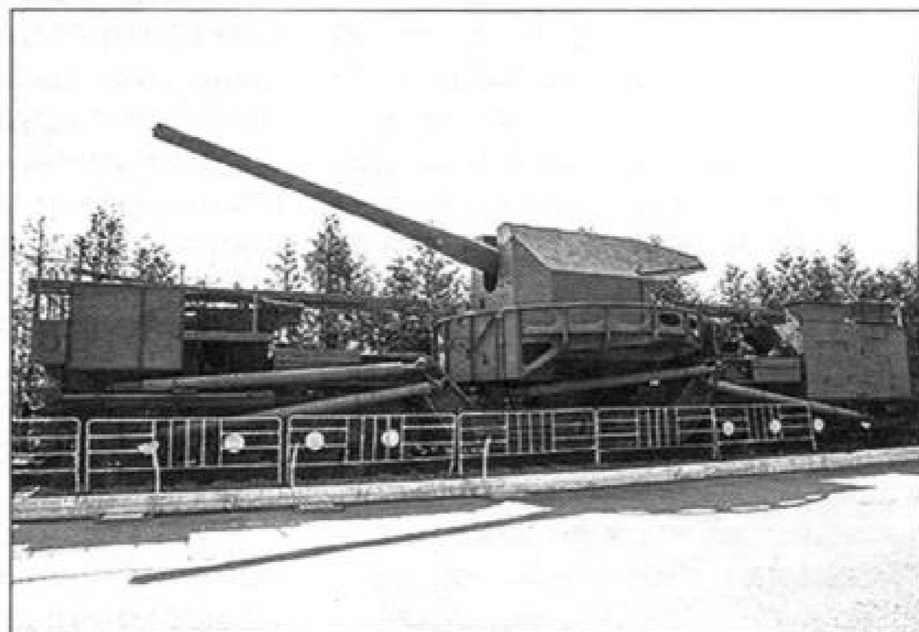
Железнодорожный транспортёр ТМ-I-180 со 180-мм пушкой
